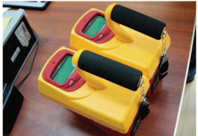
Cámara de ionización (detector de radiación).
