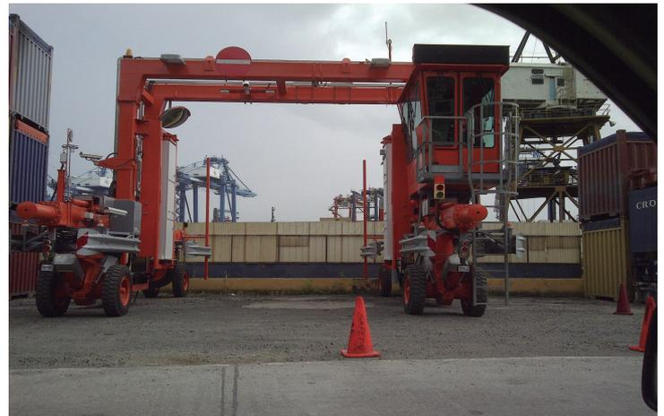
MRDIS: Sistema móvil de detección e identificación de radiación el cual puede reubicarse para inspeccionar a medida que los contenedores se transfieren entre embarcaciones o se envían a los depósitos.
